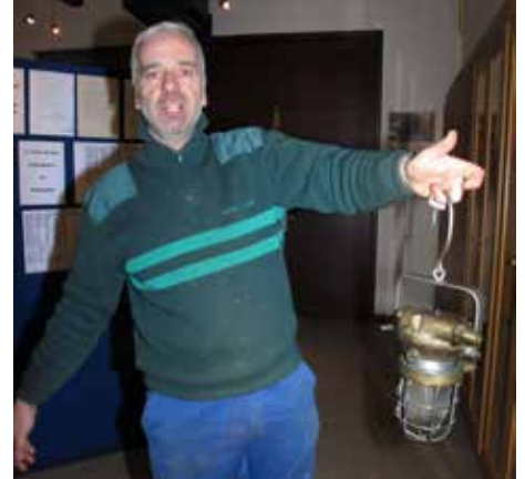
In de mijn werkt alles op perslucht. Er bestaan zelfs speciale lampen op perslucht.
