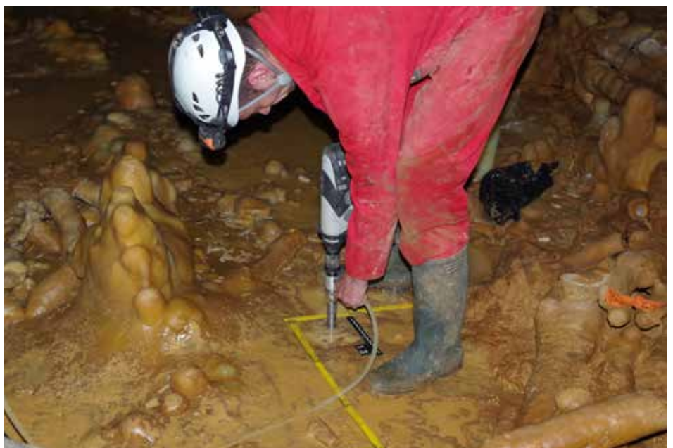
Figuur 5: Staalname van de mini-boorkernen voor de datering van de structuren. (© SSAC)
